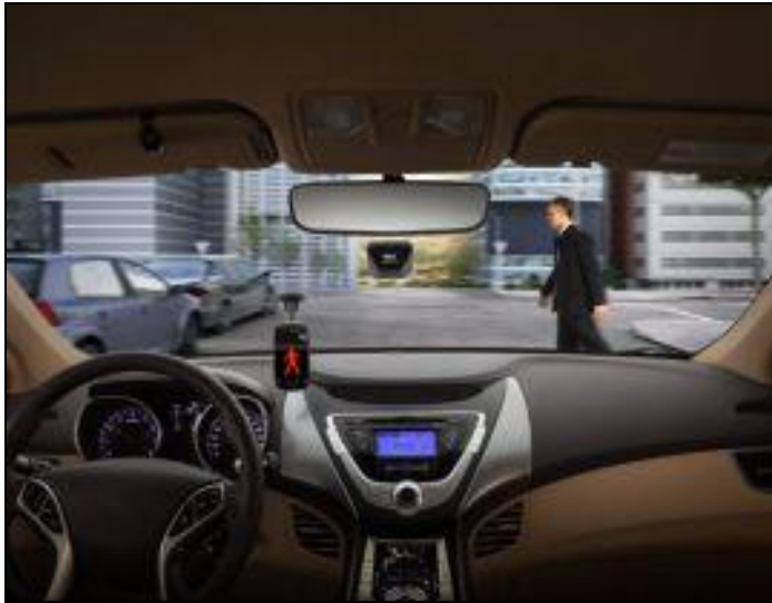
Figura 3: sistema de detecção de pedestres (V2P)
